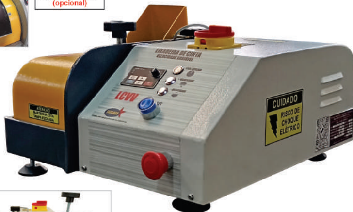
Abertura da lixa: 100mm x 20mm Abertura frontal de 100mm x 200mm (opcional)
