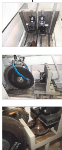
Algumas possibilidades de morsas para fixação da peça
