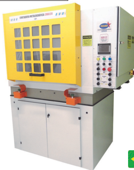
Algumas possibilidades de morsas para fixação da peça
