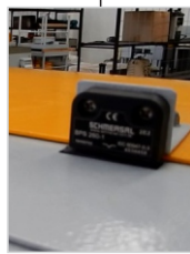
Duto prolongador de entrada do material que impede o alcance do disco
