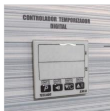
Controlador eletrônico protegido contra sobrecargas elétricas que controla: resistência elétrica de aquecimento (pirômetro), tempo de cozimento (cura) do baquelite e temperatura final do ciclo que determina o desligamento automático de todo o equipamento
