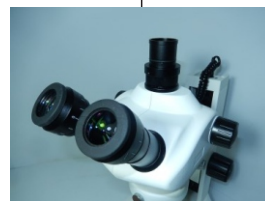
Dupla iluminação (transmitida e refletida) por sistema de LED com controles independentes de intensidade luminosa
