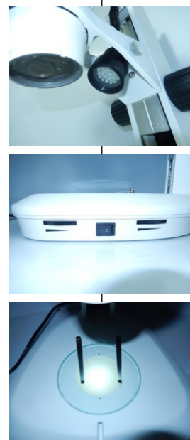
Dupla iluminação (transmitida e refletida) por sistema de LED com controles independentes de intensidade luminosa
