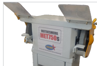
Rebolo com ângulo de exposição de 65° e apoio para ferramentas
