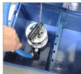
2º: Conecte a mangueira de entrada de líquido refrigerante da máquina na saída de líquido da bomba, mantendo o registro na posição "Aberto"
