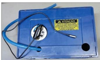
1º: Conecte a mangueira de retorno da máquina no reservatório
