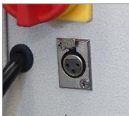
3º: Conecte o cabo de alimentação da bomba no Plug
