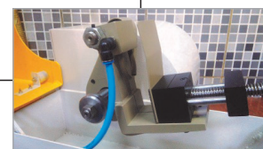
Corte acionado por alavanca que empurra a amostra contra o disco
