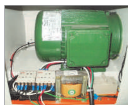
Motor blindado de alto torque (2cv/1500w trifásico)
