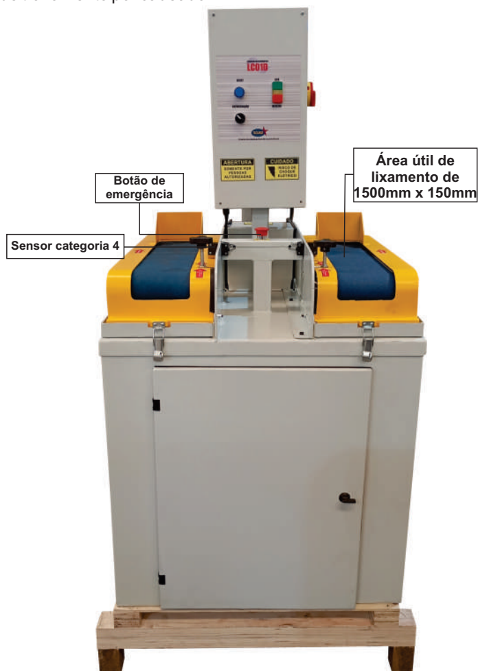
Sistema de troca de lixas pela lateral do conjunto. Mais praticidade na colocação e remoção das lixas
