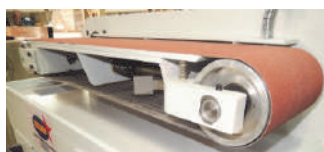
Sistema de troca de lixas pela lateral do conjunto. Mais praticidade na colocação e remoção das lixas
