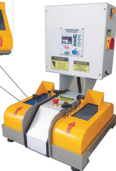
Sistema de troca de lixas pela lateral do conjunto. Mais praticidade na colocação e remoção das lixas
