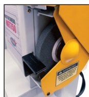
Guarnições de proteção do rebolo
